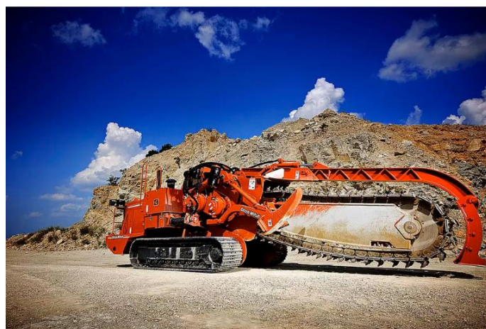
شکل (۷-۱۳) دستگاه Trenchers
