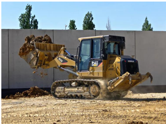
شکل (۷-۱۲) دستگاه Crawler Loaders
