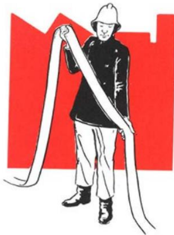
شکل (۲-۴) نحوه تخلیه شلنگ آب آتش‌نشانی
