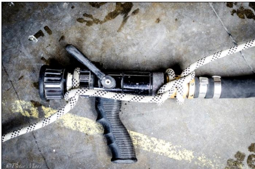
شکل (۶-۲۸) استفاده از گره هافهیچ و گره کلاوهیچ برای مهار نازل آچ پی
