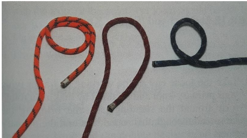
شکل (۷-۲) از چپ به راست: یک پیچش گرد، یک خمیدگی و یک حلقه
