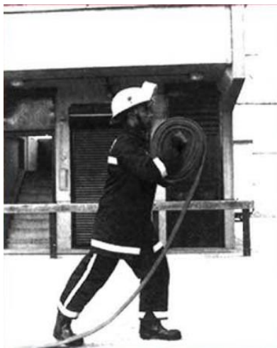
شکل (۲-۶) روش صحیح باز کردن هوزهای آب آتش‌نشانی که از قسمت female جمع شده باشند.
