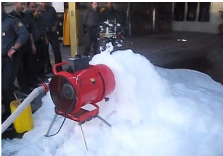
شکل (۴۲-۶) تولید کف توسط توربکس
