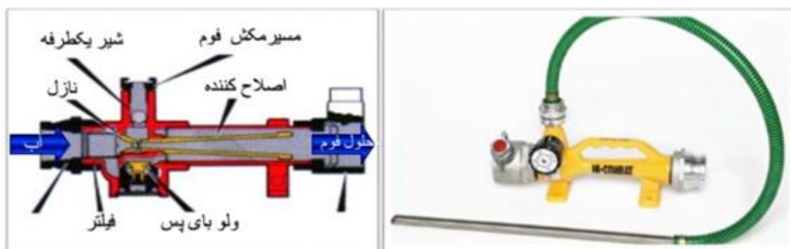
شکل (۴۵-۶) اینداکتور بین مسیر
