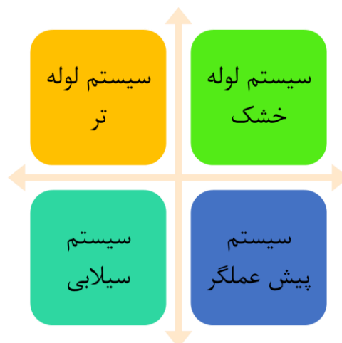
شکل (۶-۶) دسته بندی سیستم‌های اسپرینکلری
