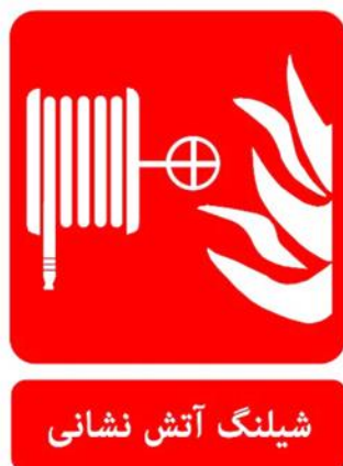
شکل (۶-۷) علائم شبرنگ بدنه جعبه‌های شیلنگ آتش‌نشانی
