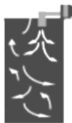
شکل (۶-۱۴) شیوه درست تهویه هوا (دمیدن هوا)
