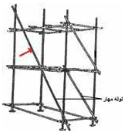
شکل (۶-۱۱) لوله های مهار
