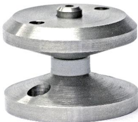
شکل (۶-۱۸) کولیماتور پانارومیک از جنس تنگستن برای ایریدیوم ۱۹۲ و سلنیم ۷۵ برای تصور برداری‌های ۳۶۰ درجه
