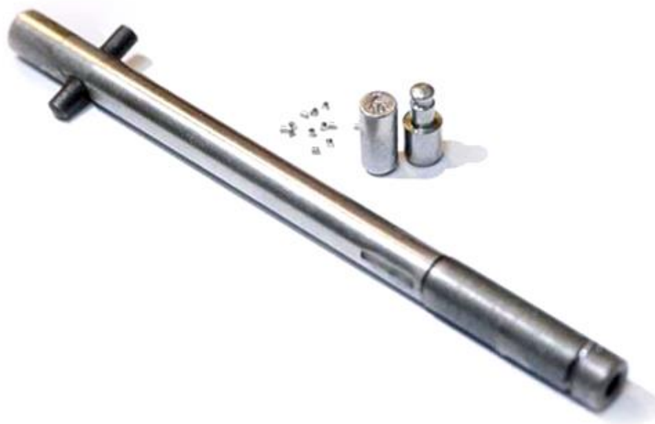
شکل (۵-۶) نمونه‌ای از چشمه‌های پرتوگامای کبالت ۶۰ به همراه کپسول و هلدِر
