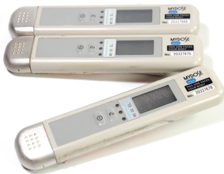
شکل (۶-۲۹) نمونه‌ای از یک دُزیمتر جیبی
