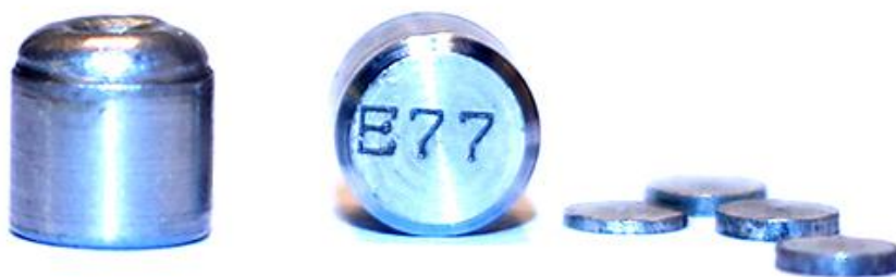
شکل (۶-۳) کپسول حاوی تعدادی دیسک یا قرص فلزی از ایریدیوم-۱۹۲
