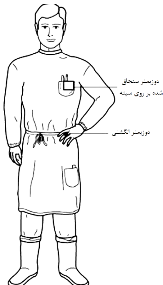
شکل (۶-۲۶) محل نصب دُزیمترهای ترمولومینسانس (TLD)
