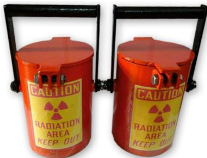
شکل (۶-۳۰) نمونه‌ای از محفظه نگهداری (کانتینر) چشمه
