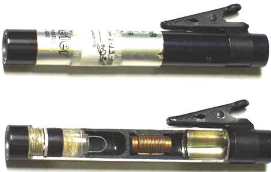
شکل (۶-۲۸) نمای داخلی یک دُزیمتر قلمی
