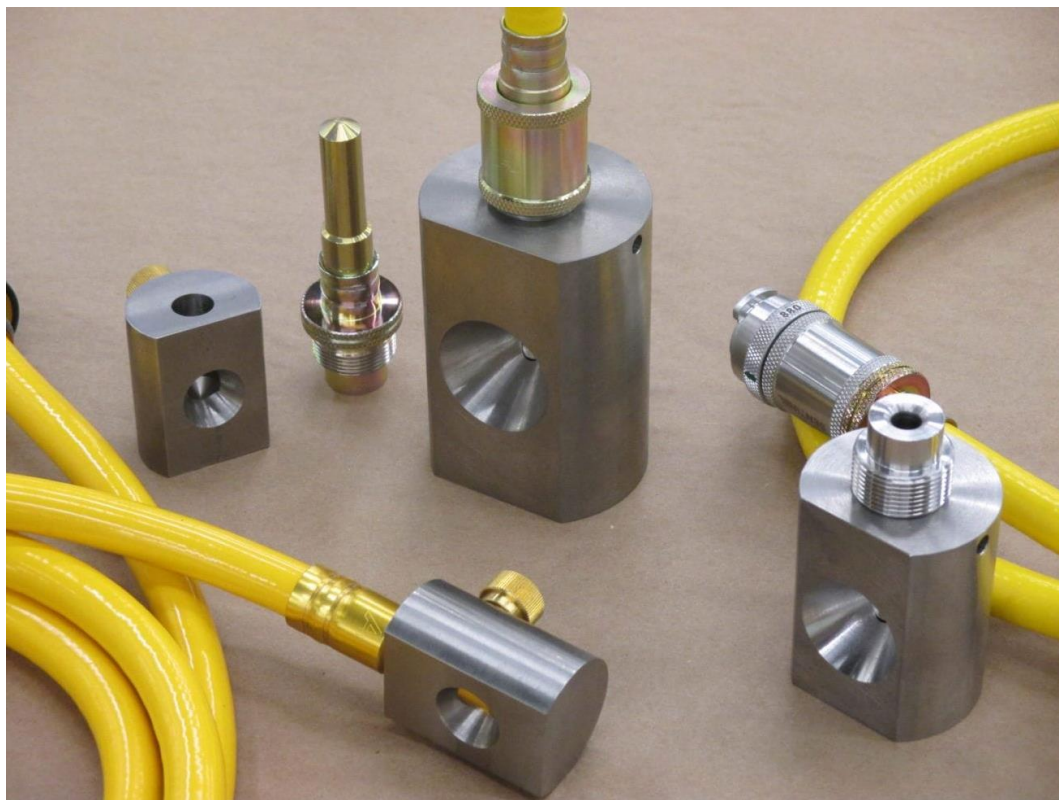
شکل (۶-۱۹) کولیماتورهای نصب شده در انتهای گاید تیوپها
