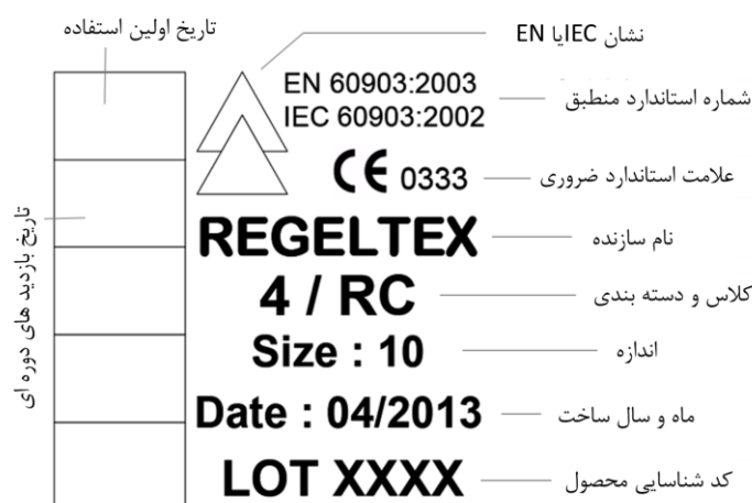
شکل (۶-۲۷) علائم روی دستکش عایق برق
