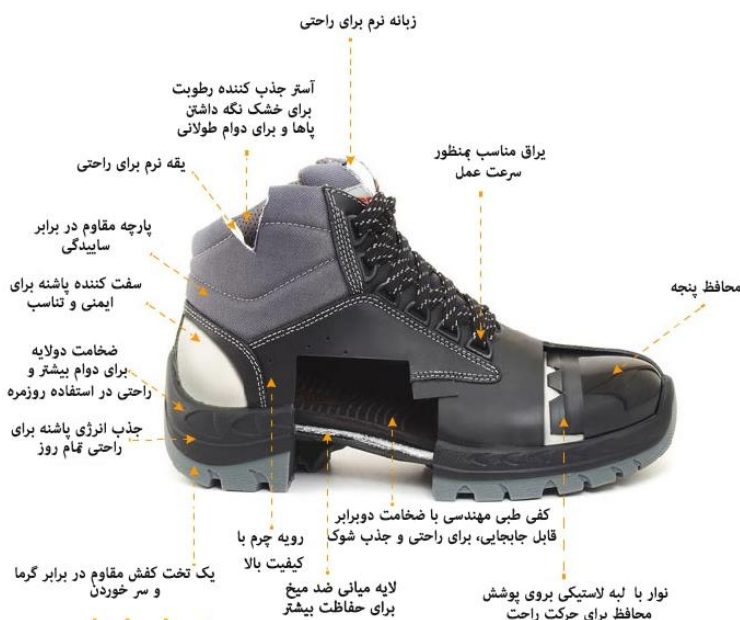
شکل (۶-۳۲) نمونه ای از ساختار یک کفش ایمنی
