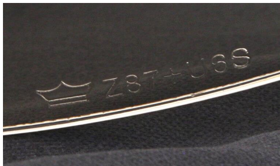
شکل (۷-۱) نمونه‌ای از علامت‌گذاری بر روی تجهیز محافظ چشم و صورت
