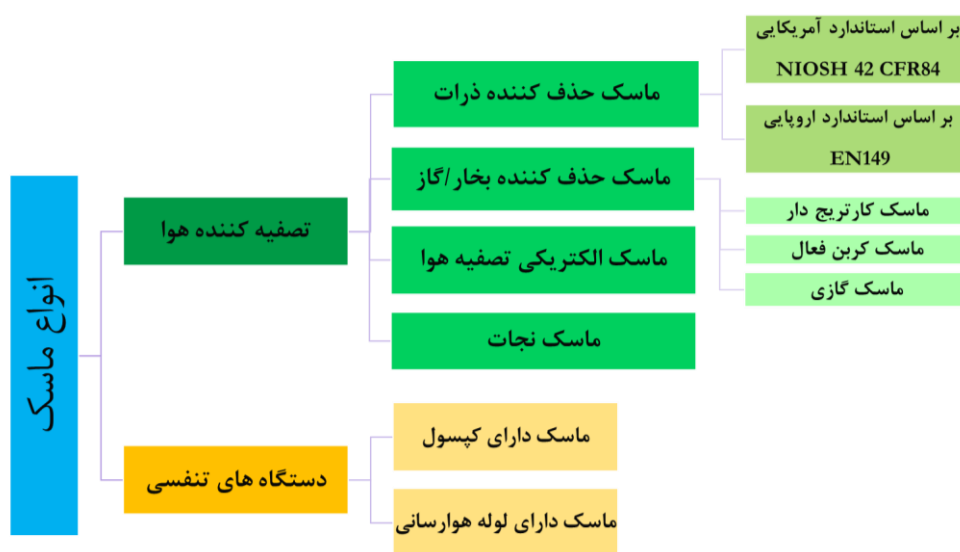
شکل (۶-۱۳) طبقه‌بندی کلی انواع ماسک‌ها
