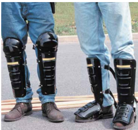
شکل (۳۷-۶) نمونه‌ای از استفاده هم‌زمان از تجهیزات محافظ ساق و روی پا
