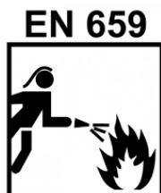
شکل (۵-۷) نشانه گذاری روی دستکش های آتش نشانی
