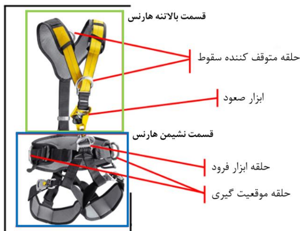
شکل (۳۱-۶) اجزای اصلی هارنس دسترسی به طناب صنعتی
