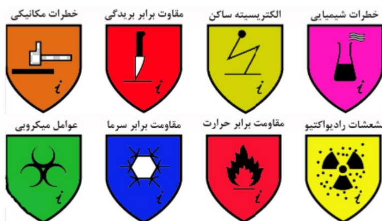
شکل (۶-۲۵) علائم اختصاری مندرج بر روی دستکش‌ها
