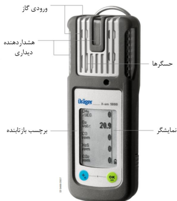
شکل (۶-۷) اجزای اصلی تشکیل دهنده دستگاه گازسنج (آشکارساز)
