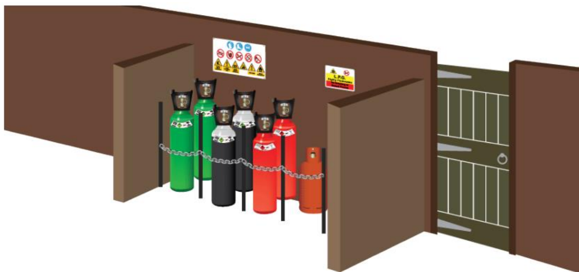
شکل (۱۶-۶) نمونه‌ای از محل قرارگیری سیلندره‌های گاز در محیط محافظت‌شده
