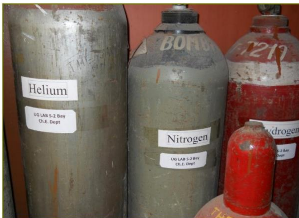
شکل (۹-۶) شناسه صحیح محتوای سیلندر- برچسب سیلندر
