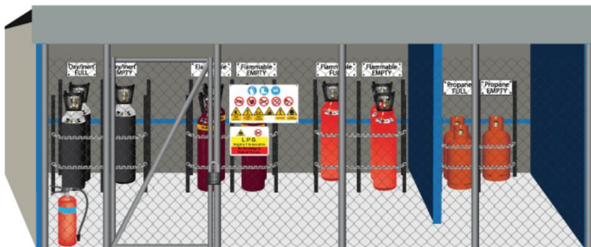
شکل (۱۵-۶) نمونه‌ای از نحوه صحیح انبارش سیلندره‌های گاز از انواع مختلف در محوطه بیرون
