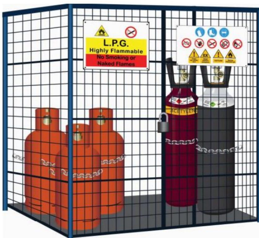
شکل (۶-۱۰) شماتیکی از محفظه نگهداری سیلندرها و برچسب‌گذاری آنها
