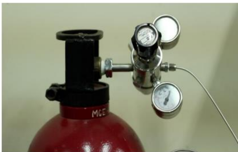
شکل (۵-۶) اتصالات و رگلاتورهای فشار سیلندرها
