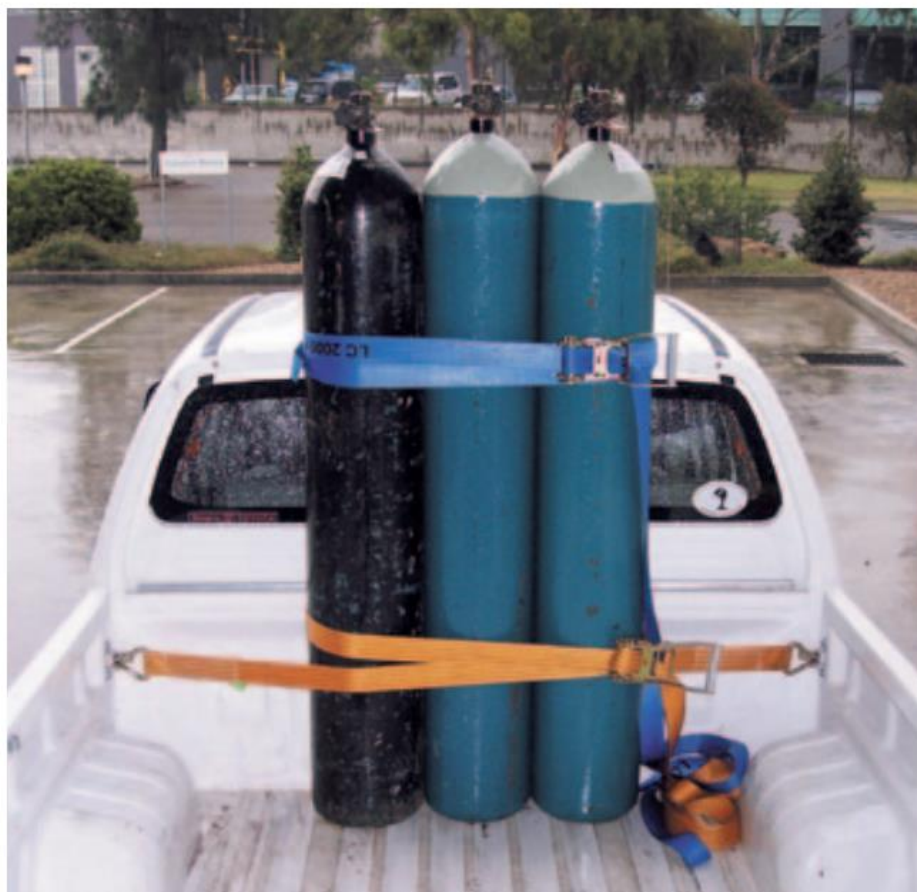
شکل (۶-۱۳) نحوه صحیح مهار نمودن و حمل سیلندره‌ای گاز با خودرو
