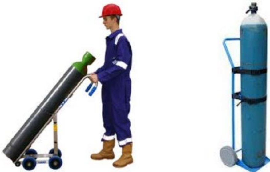
شکل (۸-۶) نحوه صحیح حمل دستی سیلندرهای گاز و استفاده نقرات از البسه استحضافی به هنگام حمل سیلندر
