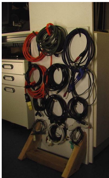
شکل (۶-۷) مرتب نمودن کابل‌های برق دستگاه‌ها و تجهیزات پرتابل و مهار نمودن آن‌ها بر روی دیوار یا در یک تکیه‌گاه ثابت
