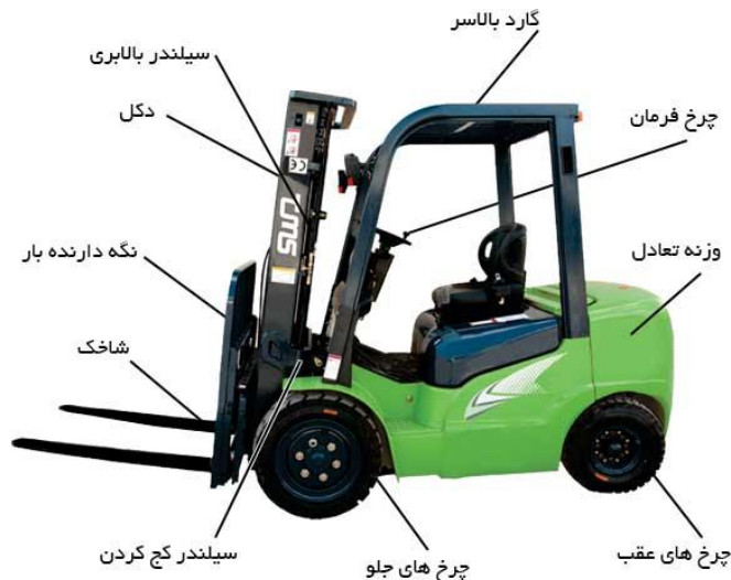
شکل (۶-۱۰) اجزاء مختلف لیفتراک
