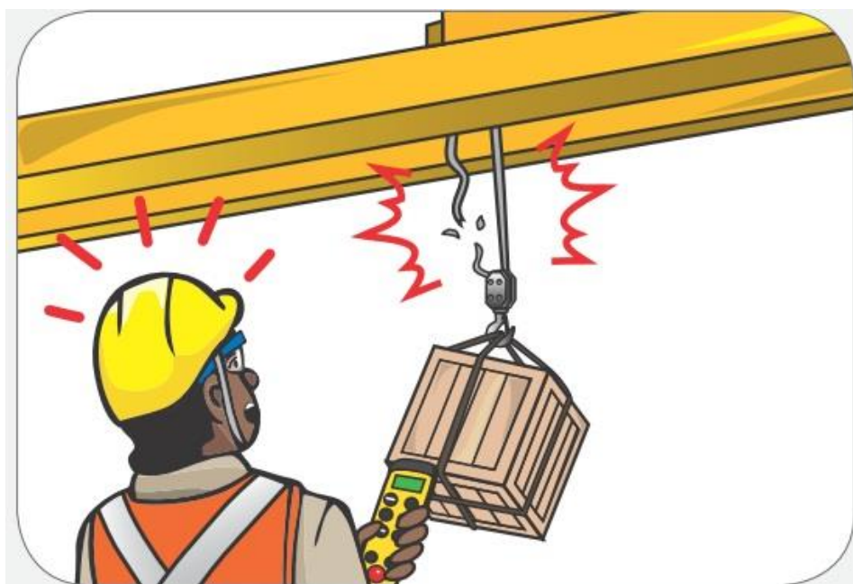
شکل (۲-۶) پاره شدن طناب بالابر بر اثر بلند کردن بار بیش از حد مجاز
