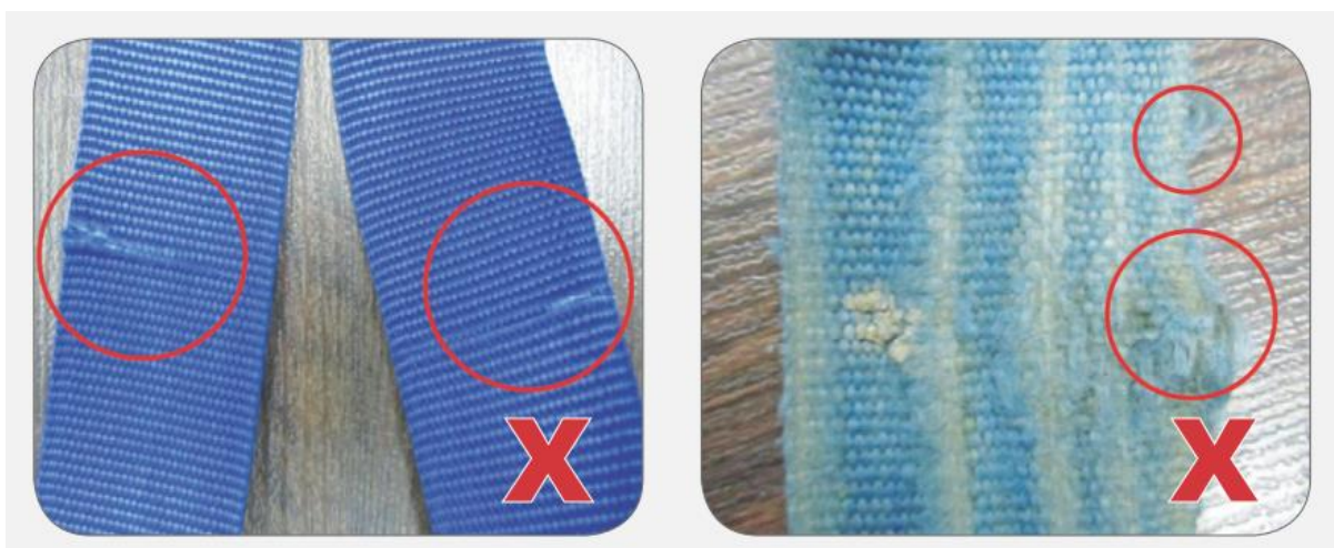
شکل (۴۴-۶) عیوب موجود در اسلینگ‌ها
