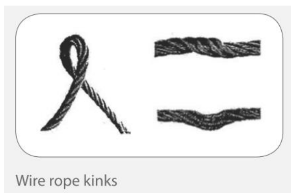
شکل (۶-۳۰) حالات خرابی طناب یا کابل جرثقیل
