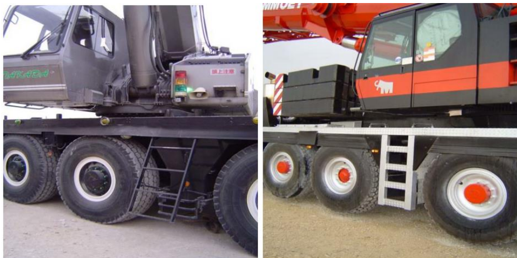
شکل (۶-۲۲) راه دسترسی ایمن به کابین
