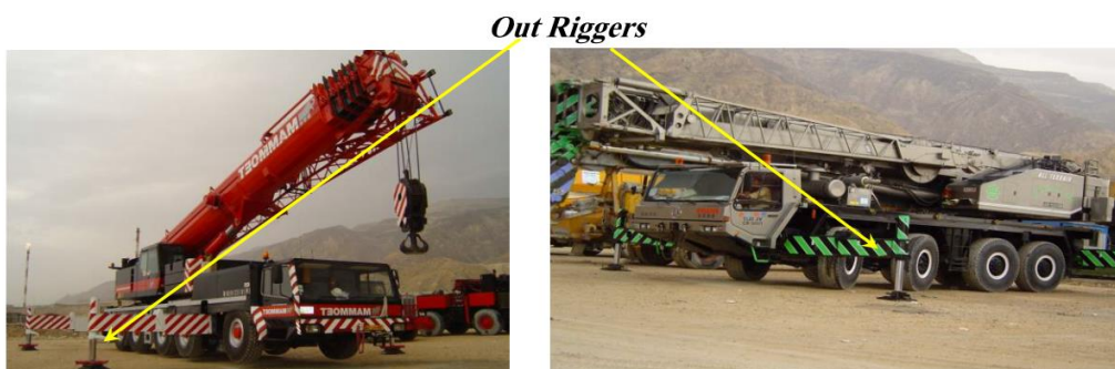
شکل (۱۱-۶) نحوه مناسب قرار گیری جک‌ها
