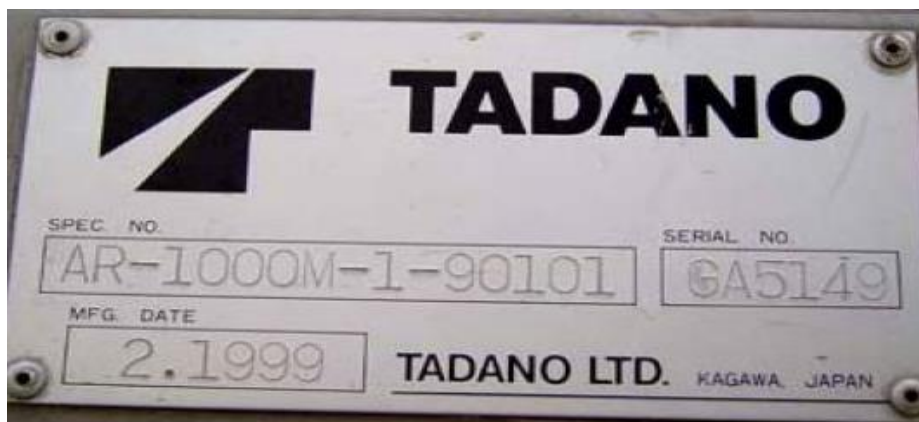
شکل (۶-۲) نمونه پلاک شناسایی جرثقیل
