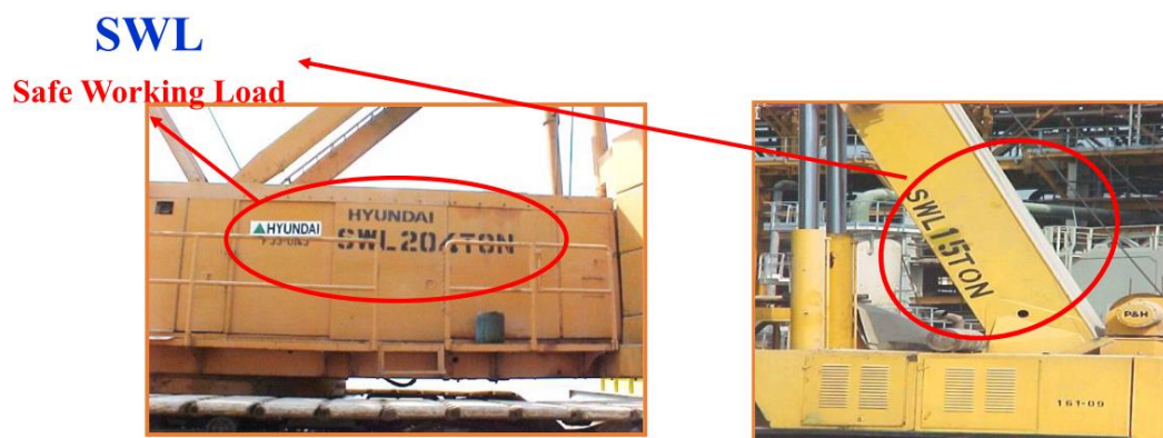
شکل (۹-۶) درج میزان ظرفیت بار مجاز بر روی بدنه جرثقیل
