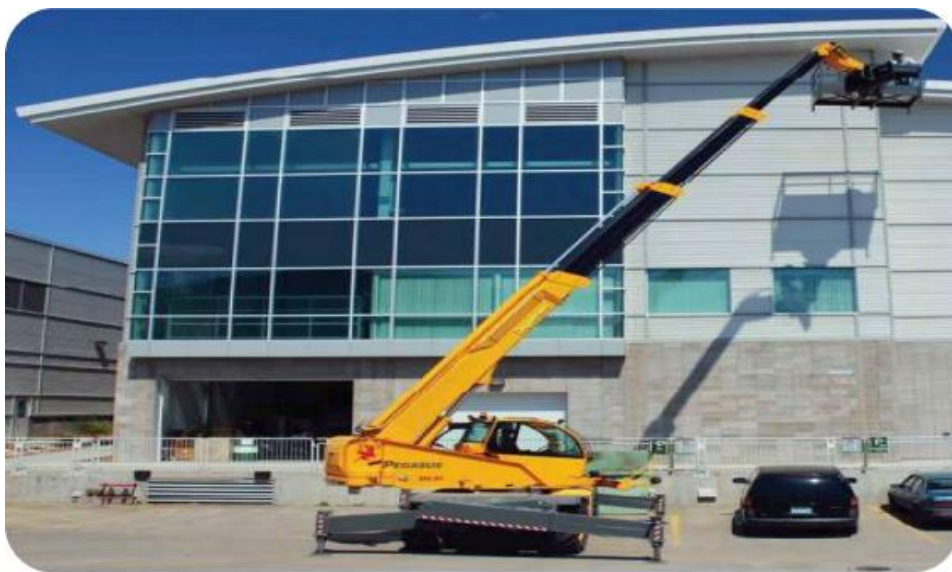
شکل (۳۷-۶) حمل نفر با سبد جرثقیل
