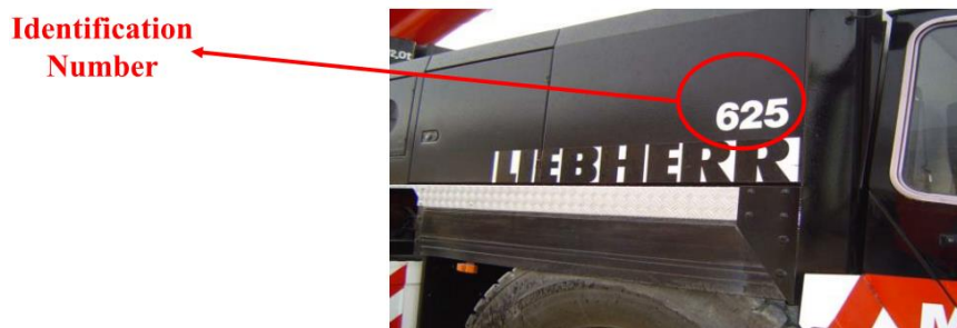
شکل (۱۰-۶) شماره شناسایی جرثقیل
